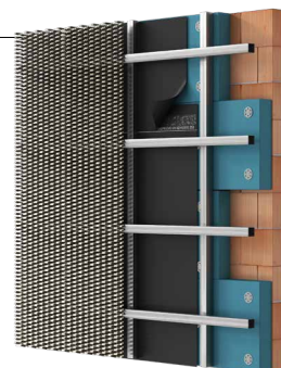
Façade ventilée à joints ouverts avec isolation en EPS protégée par une membrane résistante aux rayons UV.
