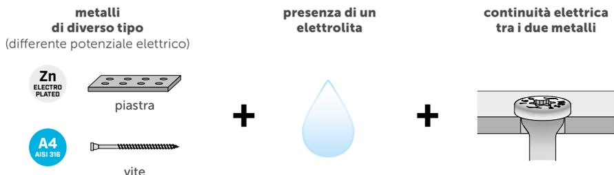
Più dissimili sono i metalli (maggiore differenza di potenziale), maggiore è il rischio di corrosione. Il potenziale di corrosione galvanica tra i metalli è dettato da quanto sono distanti sulla "serie galvanica di metalli". In modo approssimativo, una differenza di potenziale maggiore di 0.4-0.5 V potrebbe considerarsi significativa/critica.
