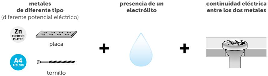
Cuanto más diferentes sean los metales (mayor diferencia de potencial), mayor será el riesgo de corrosión galvánica. El potencial de corrosión galvánica entre los metales depende de lo distantes que tienen en la serie galvánica de metales. En general, una diferencia de potencial superior a 0,4-0,5 V puede considerarse significativa/crítica.
