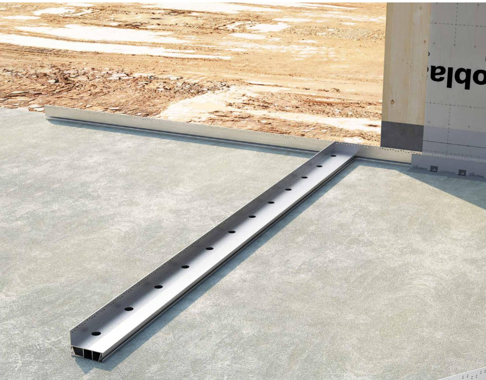
Il profilo ALU START consente di eliminare il contatto tra i pannelli in legno e la sottostruttura in calcestruzzo, garantendo protezione dall'umidità di risalita capillare e assicurando eccellente durabilità all'attacco a terra dell'edificio. È il primo sistema di connessione a terra che permette di eliminare hold-down e angolari a taglio. In lega di alluminio, il sistema ALU START può essere utilizzato con pareti in X-LAM o sistema costruttivo timber frame.
