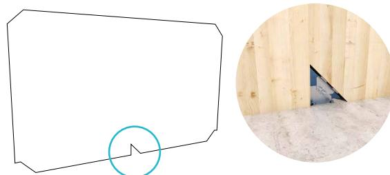
Cuando se requiere una fijación a los cimientos de paredes no estructurales o una fijación temporal para alinear correctamente una pared (por ejemplo, paredes de longitud considerable), es posible instalar en la esquina inferior del panel de CLT (con un corte a 45° simplificado sin rediente horizontal) la placa BEASYT (en lugar de X-ONE) y en la placa de fundación la placa BEASYC (en lugar de las placas X-PLATE BASE).
