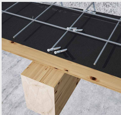
^ Laje colaborante madeira-betão com disposição conectores a 30° em fileira dupla.
