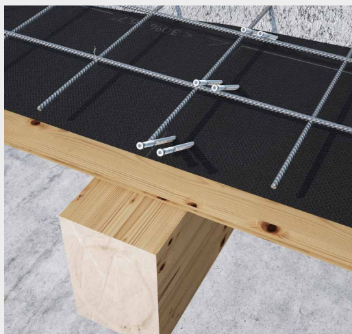
Verbunddecke Holz-Beton, Verbinder in zwei Reihen auf 30° ausgerichtet.
