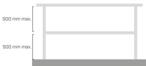
BARANDA SIN RODAPIÉ
